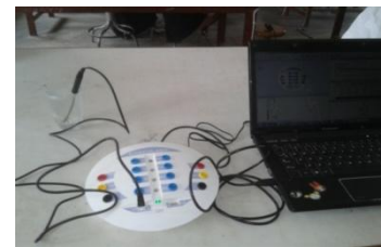
Gambar 2. Rangkaian menghubungkan perangkat laptop ke sensor suhu
